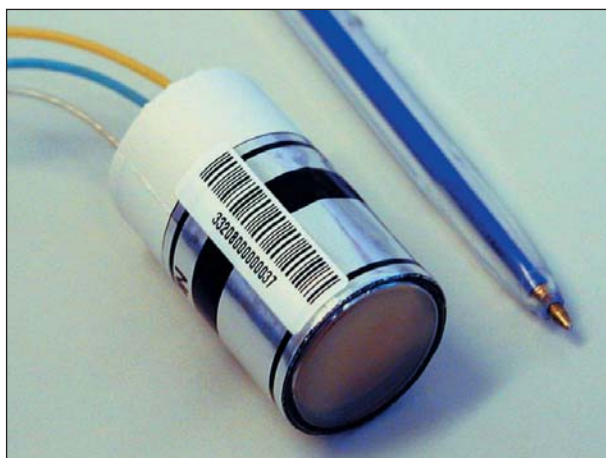
ЦНИИ «Электрон» (Санкт-Петербург) выпустил 15 тыс. вакуумных фототриодов для торцевой части калориметра.
